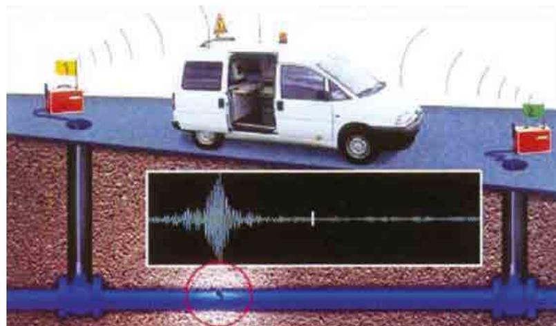
Une fois la zone de bruit la plus importante identifiée, le technicien va pouvoir utiliser un « corrélateur acoustique ». En installant deux capteurs de part et d'autre de la zone fuyarde, le technicien va localiser la fuite (la fuite générant un « pic » de corrélation), à quelques mètres près permettant ainsi de réduire considérablement la zone de terrassement (schéma ci-contre).
