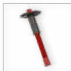
La **broche ou burin** est un outil de maçon bien connu utilisé avec marteau ou massette. La pointe peut être aussi en ciseau.
