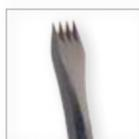
La **gradine** est un outil utilisé pour la taille de la pierre. C'est un ciseau très effilé, muni de trois à six dents. Il sert à dégrossir les parements en pierre ferme telle que le marbre
