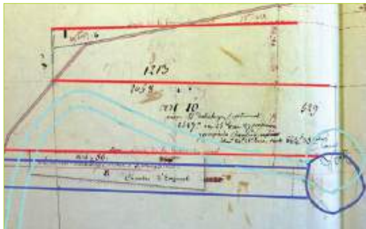
Le Creux de Suzon, 1810, ADCO, plan annoté par l'auteur : ancienne rigole en bleu clair et nouvelle en bleu foncé.
